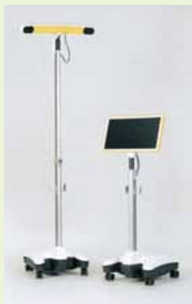
ナビゲーションシステム（使用している器具と神経や血管との位置関係をリアルタイムで確認できます）
